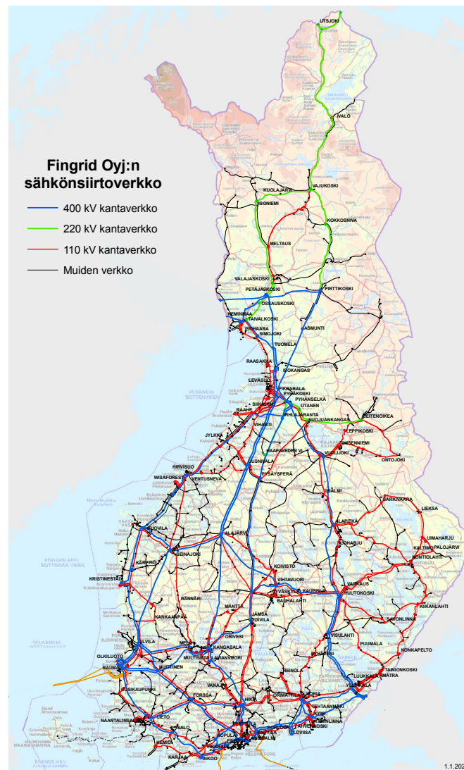
Kuva 32. Fingrid Oyj:n sähkönsiirtoverkko.
